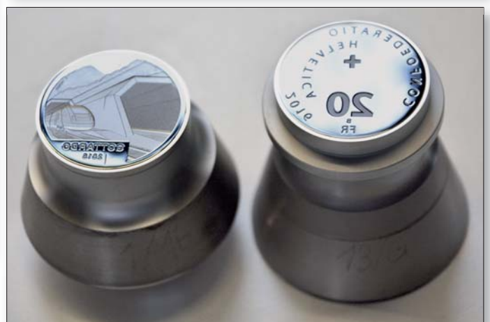
In einer Fräs- und Graviermaschine der Firma Lang wird ein digitales Modell eingelesen und in einen Stempel umgesetzt (Foto: Lang GmbH & Co. KG).
