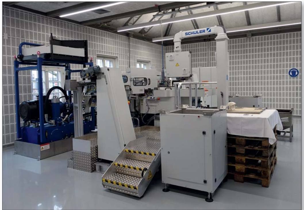
Münzen mit Spezialtechnologien sind in der Herstellung oft komplizierter. Diese Maschine der Firma Schuler steht in der Staatlichen Münzstätte Karlsruhe und dient zum Zusammenfügen von Ronden mit Polymerring (Foto: UK).
