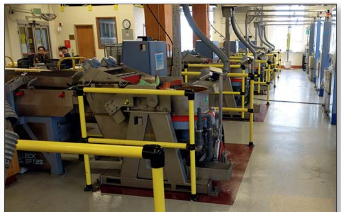
Waschstraße: Die Maschinen der Firma Spaleck in diesem Raum der Münzstätte in San Francisco dienen alle dem Vorbereiten der Rondens (Foto: UK).
