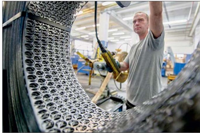
So sieht ein Coil aus, wenn die Metallblättchen für die Ronden herausgestanzt wurden. Man spricht vom Stanzgitter (Foto: Monea).
