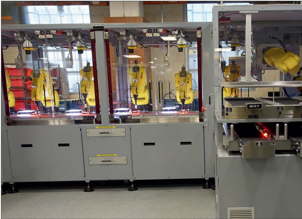
Eine Batterie an autonomen Greifarmen baut in der Münzstätte in San Francisco vollautomatisch die Kursmünzensätze zusammen (Foto: UK).
