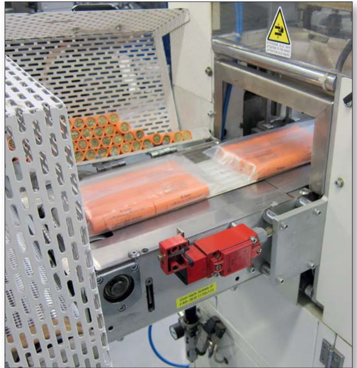
Auf diesem Förderband in der Münzstätte in Stuttgart werden Münzen zunächst in Rollen verpackt und anschließend die Rollen portionsweise eingeschweißt (Foto: UK).
