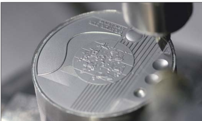
In einer Fräs- und Graviermaschine der Firma Lang wird ein digitales Modell eingelesen und in einen Stempel umgesetzt (Foto: Lang GmbH & Co. KG).
