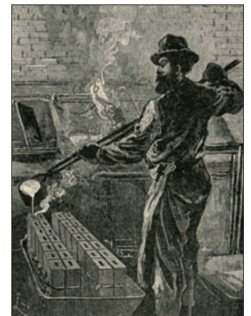
Ein Schmelzer beim Gießen der Barren.
