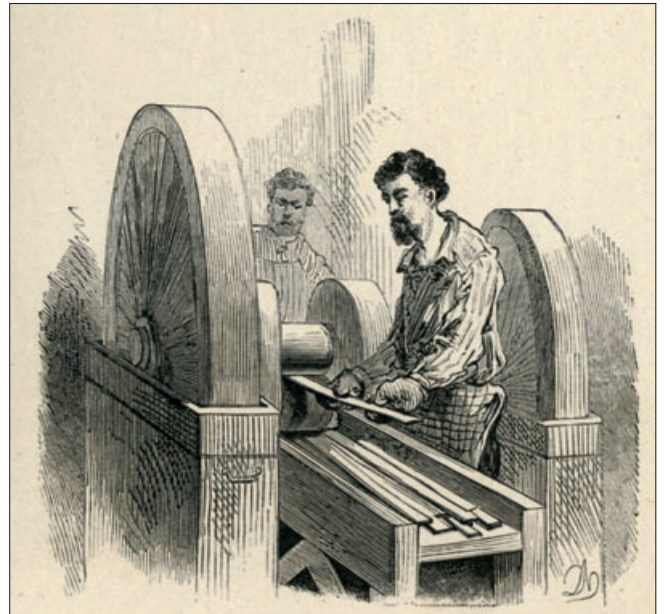
Walzwerk, auf dem die Barren zu groben Zainen ausgezogen werden.
