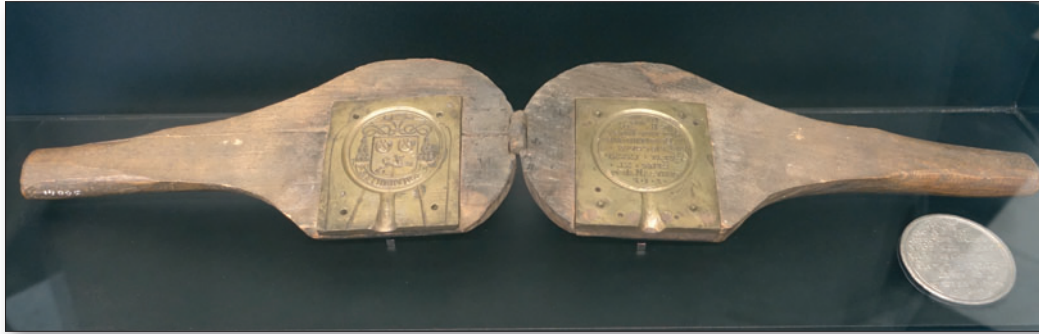
Formzange für eine Marke, unten rechts eine damit hergestellte Medaille. STAM, Gent, Inv. 14005 (Foto: KW).
