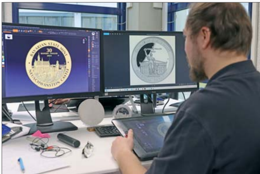
Im Bayerischen Hauptmünzamt in München werden die Entwürfe am PC für die Stempelherstellung digital modelliert.
